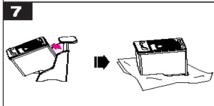
Lepaskan kartrid dari refill clip, bersihkan sisa tinta pada lubang pengisian dan headprint dengan tissue. Setelah bersih test aliran tinta dengan mengusap tissue pada permukaan headprint. Semua warna harus terlihat berbekas pada tissue.
